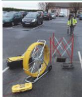
Une sonde, raccordée à un générateur, ou autonome alimentée par piles, fixée à l'extrémité d'un jonc flexible de différents diamètres et de différentes longueurs, est introduite dans la canalisation. Elle émet un signal électromagnétique. Un récepteur en surface permet de suivre le signal.
