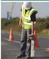
Mesure du champ électromagnétique émis par un câble sous tension et soumis à un courant (méthode passive)
