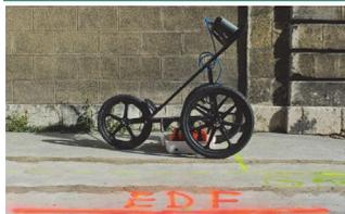
une antenne émetteur-récepteur envoie une onde radar qui se propage dans le sous-sol
