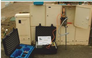
injection dans le fluide ou sur la canalisation d'un signal acoustique et détection des vibrations par un récepteur à la surface du sol
